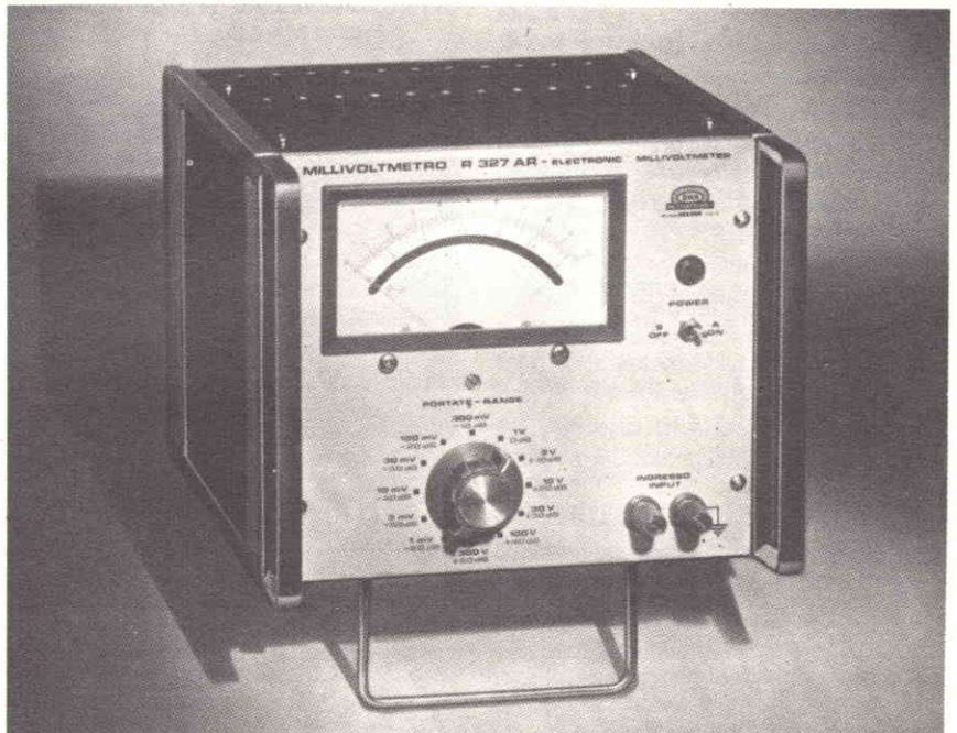
Fig. 7 - Millivoltmetro a transistori della UNAOHM, modello R327AR, per misure a larga banda, da 5 Hz a 3 MHz, per valori compresi fra 100 \mu V e 300 V.
