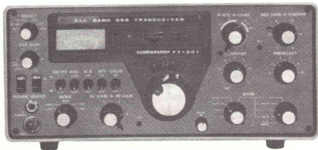
Fig. 3 - Il rice-trasmittitore Sommerkamp FT277B per tutte le gamme radioamatori, CB, più la banda marina, compresa la frequenza di 2128 kHz, e la gamma dei 10 MHz, sola ricezione, per frequenze standard e segnali orari. Emissioni AM, SSB e CW. Alimentazione in alternata 110 ÷ 220 V e in continua 12 V.
