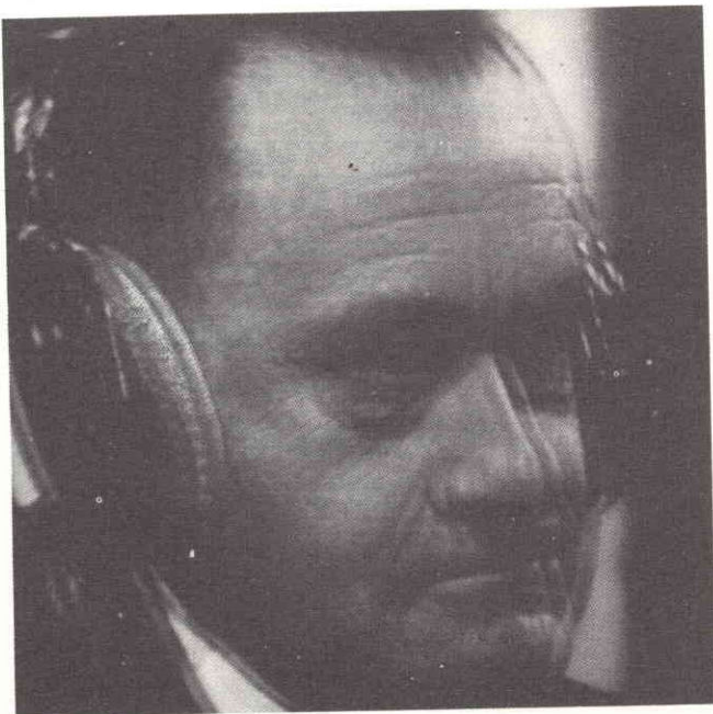
Fig. 11 - Immagine con riflessioni a destra. La più debole delle immagini appare alla destra della più marcata. Rimedio: impiego di un'antenna con forte effetto direttivo, eventualmente scelta di un altro punto di allestimento.
