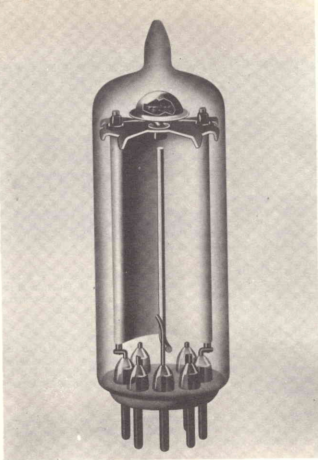
Fig. 34 - Esempio di sfruttamento dell'effetto fotoelettrico «esterno» nella cellula fotoelettrica 90 CV (a sinistra) e 58 CV (a destra). Entrambe presentano la massima sensibilità al rosso.
